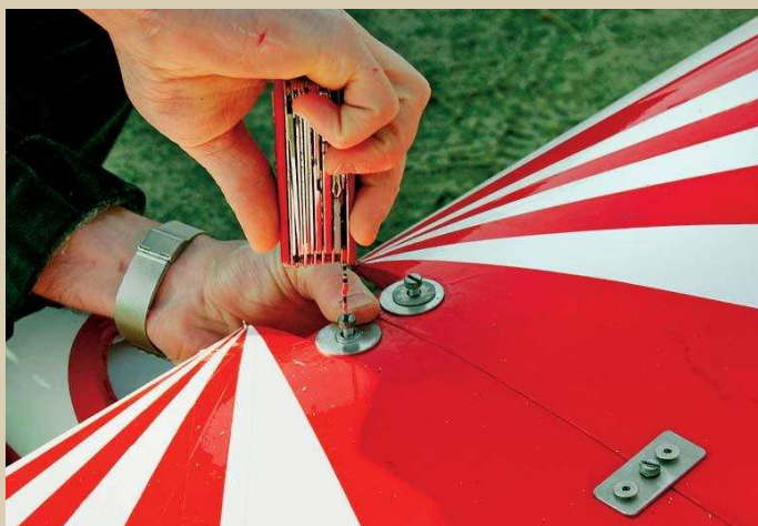
Auch das Höhenleitwerk wird mit zwei Stahlschrauben befestigt
